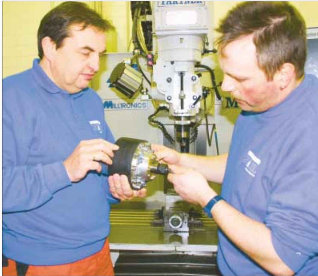
Findig: Firmenchef Karl Stieler (links) und sein Mitarbeiter Holger Urban inspizieren das Roboterwerkzeug, das gegossene Motorblöcke entgratet. Spindel, nehmen sie das ruckfrei in Gummi gelagerte Teil, das einen Schleifkopf präzise führt.
