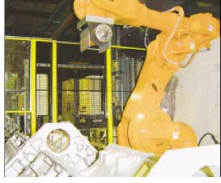
Feinschliff: Ein Roboter, der in Hatterode ausgerüstet wurde, erledigt an einem drei Zentner schweren Achtzylinder Motorblock von Isuzu die Feinarbeit. FOTO: HORNICKEL
